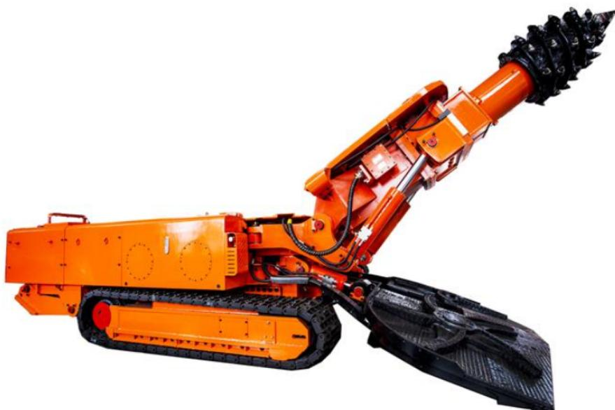
掘进机机头不转：如果机头不转，如果是在切割工作中发生，说明电机过载。现象是机头入煤壁太深，有闷声应立即关闭电机，否则会烧坏电机。正常运行中机头不转，通常是电控故障。掘进机采摘失败排除早期设计和制造因素，应检查滚筒上切割齿的排列和配置。采煤机滚筒上截齿的布置应与煤层特征相匹配，并与采煤机技术参数的配置相一致。很多煤矿的截齿损耗极高，与这个原因密切相关；可能还有另一种情况，挑库类型不适合。由于不同地区煤层的物理力学性质不同，不同型号的采煤机在运行过程中运动学参数会有所不同，同一截齿类型的适应性非常有限。在井下生产中，如果截齿类型选择不当，很容易造成采煤机滚筒截齿失效。青海综掘机厂家直销掘进机履带马达由于先导管原因造成的履带不转动，应拆卸并检查先导管，或更换新的先导管。
