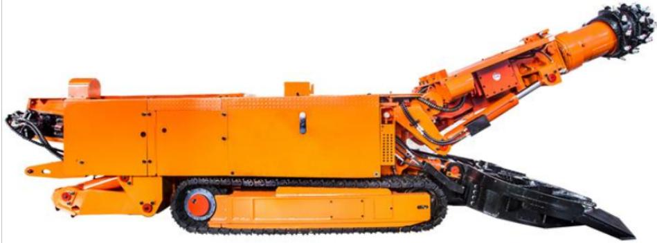
悬臂式掘进机是一种截割功率较高、功能优化升级的小型多功能掘进机。该机结构紧凑，外形美观，操作灵活，工作范围广，可靠性高，拆装、下井、组装方便，尤其是切割臂可弯曲，耙料能力强。该机还可配备液压钻机，用于煤巷瓦斯和水的勘探；根据不同的工矿条件，可更换破岩机、破碎锤、铲斗，进行破岩、爆破、耙料功能；它还可以为锚钻提供电源接口，这就是**EBH45**掘进机的多功能性。该机不仅适用于中小型煤矿隧道、水利工程、地铁隧道和各种矿山隧道的掘进和城市地下作业，还适用于大型煤矿隧道的顶板修复、侧刷和切底，尤其适用于煤矿隧道中经常出现的底鼓现象。该机体积小、工作范围灵活、移动方便，切底效率明显，具有其他掘进机无法比拟的优势。
